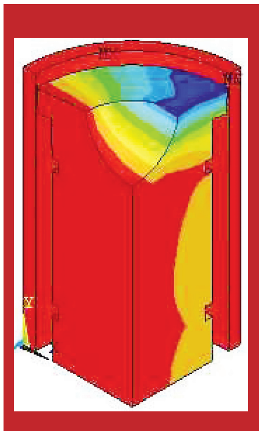
Figura 9. Desplazamientos horizontales máximos y mínimos.
