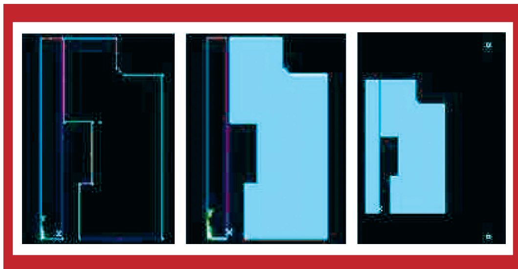
Figura 5. De izquierda a derecha, generación de puntos y líneas, formación del área transversal de la herramienta así como de la camisa.
