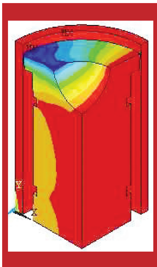
Figura 8. Desplazamientos horizontales máximos y mínimos.
