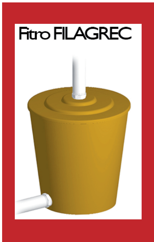
Figura 1. Vista de frente del Filtro de Reciclaje de Aguas Grises FILAGREC, con tubo alimentador, y tubo de distribución al huerto. (Guzmán, 2007 dibujo técnico Jonhatan Pacheco)
