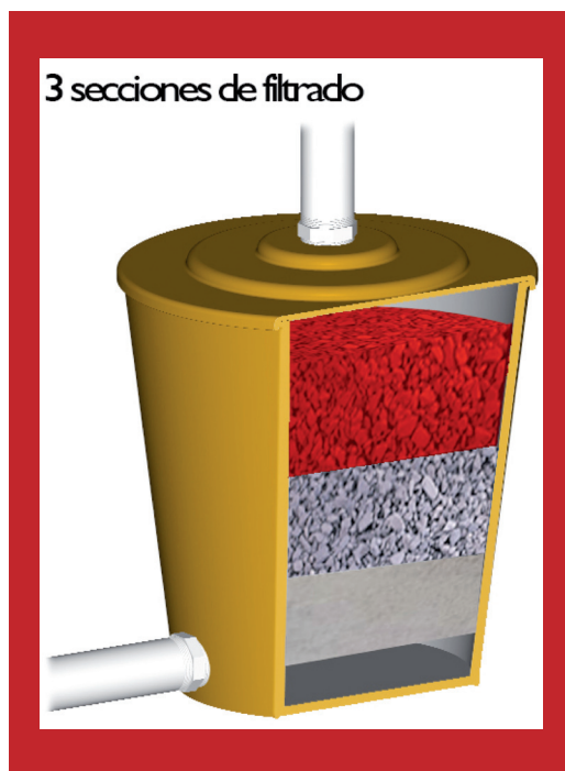
Figura 3. Corte interior del Filtro, se muestran las secciones de materia filtrante (Guzmán, 2007 dibujo técnico Jonhatan Pacheco)
