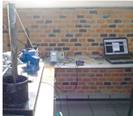
Fig.1. Equipo utilizado en la obtención de frecuencias naturales.
