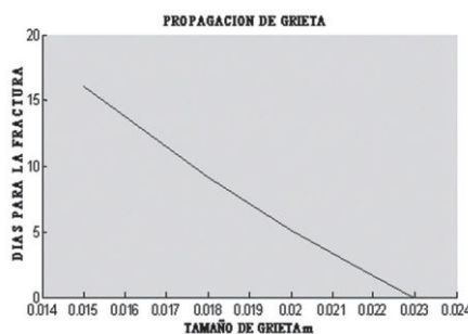
Fig. 8. Propagación de grieta en grupo de álabes.
