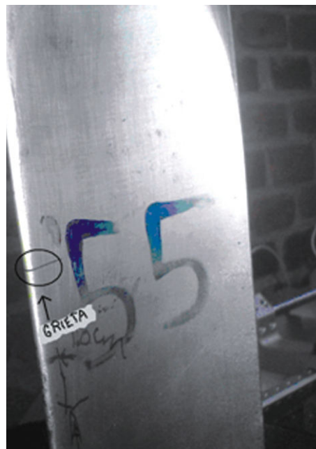
Fig. 2. Grieta en la orilla de ataque del flujo de vapor del álabe de la etapa L-0
