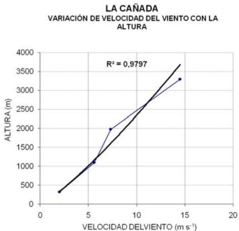
Figura 8. Variación de la velocidad del viento con la altura, en La Cañada. Valores extrapolados con base en las observaciones.
