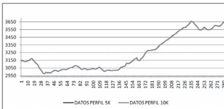
Figura 3. Perfiles obtenidos de las alturas en las superficies Raster 5K (Referente) y Raster 10K.
