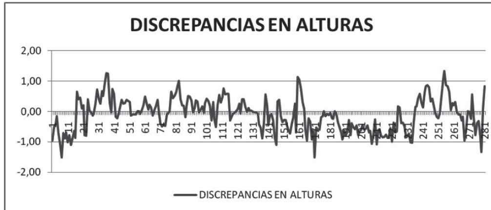
Figura 4. Discrepancias de las alturas entre las superficies Raster 5k (Referente) y Raster 10k.
