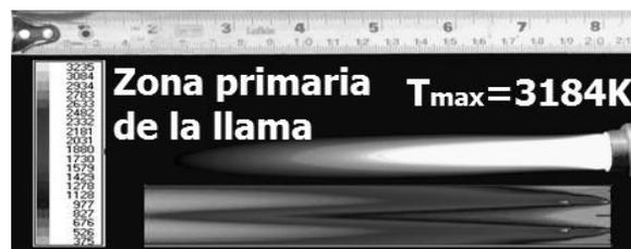
Fig. 2. Imagen de la llama altamente oxidante y de la respectiva simulación de la llama producida con una relación en volumen  $\text{C}_2\text{H}_2:\text{O}_2$  de 1:4,2. Las temperaturas están dadas en K. Fuente: [25], [26]
