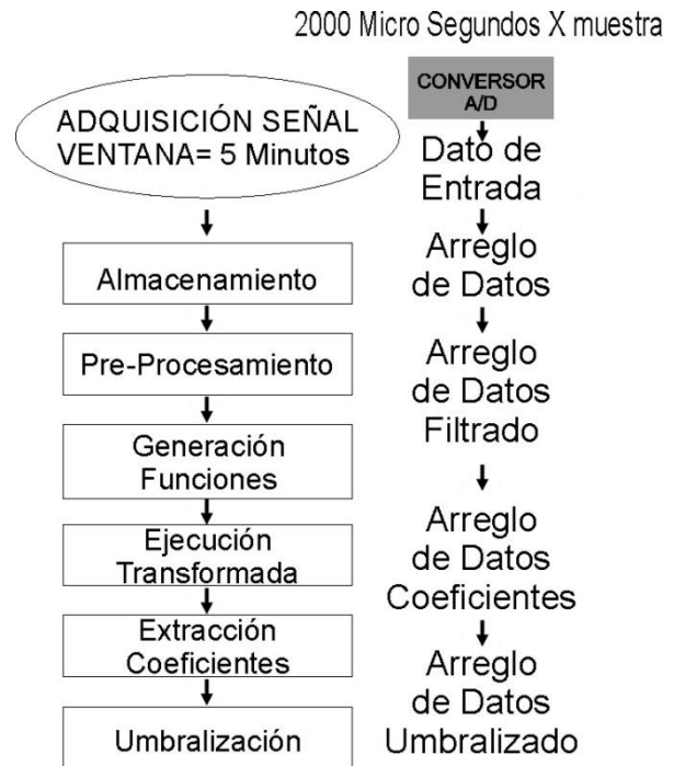
Fig. 2. Diagrama de bloques del procedimiento para extraer la onda R a partir de transformadas tiempo-frecuencia. Fuente: Autores
