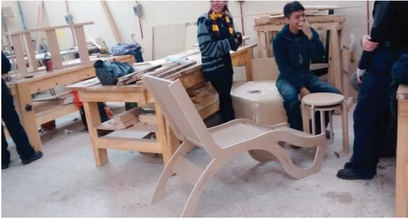
Figura 7.- Fabricación del prototipo del mobiliario para espacios comunitarios en material MDF . Foto: ERW
