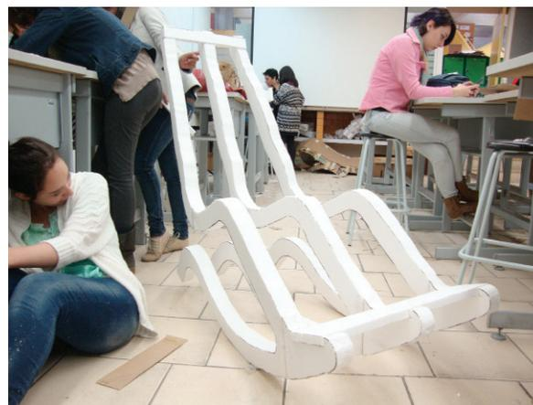
Figura 6.- Elaboración de la maqueta tamaño 1:1 del mueble en espuma de poliestireno. Foto: ERW
