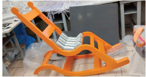
Figura 8.- Elaboración de acabados, pintura y tapicería para el prototipo del mueble. Foto: ERW
