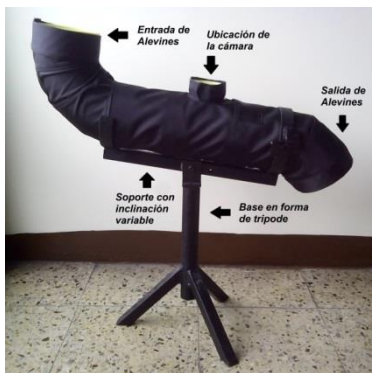
Fig. 1. Estructura del dispositivo con base en forma de trípode y conducto de flujo de alevines
