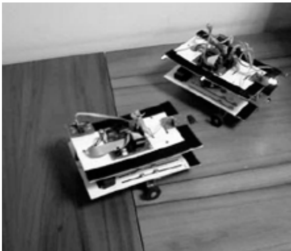
Fig. 2. Primera etapa en la construcción de los kits TEAC 2 H-RI. Montaje de la estructura base.
