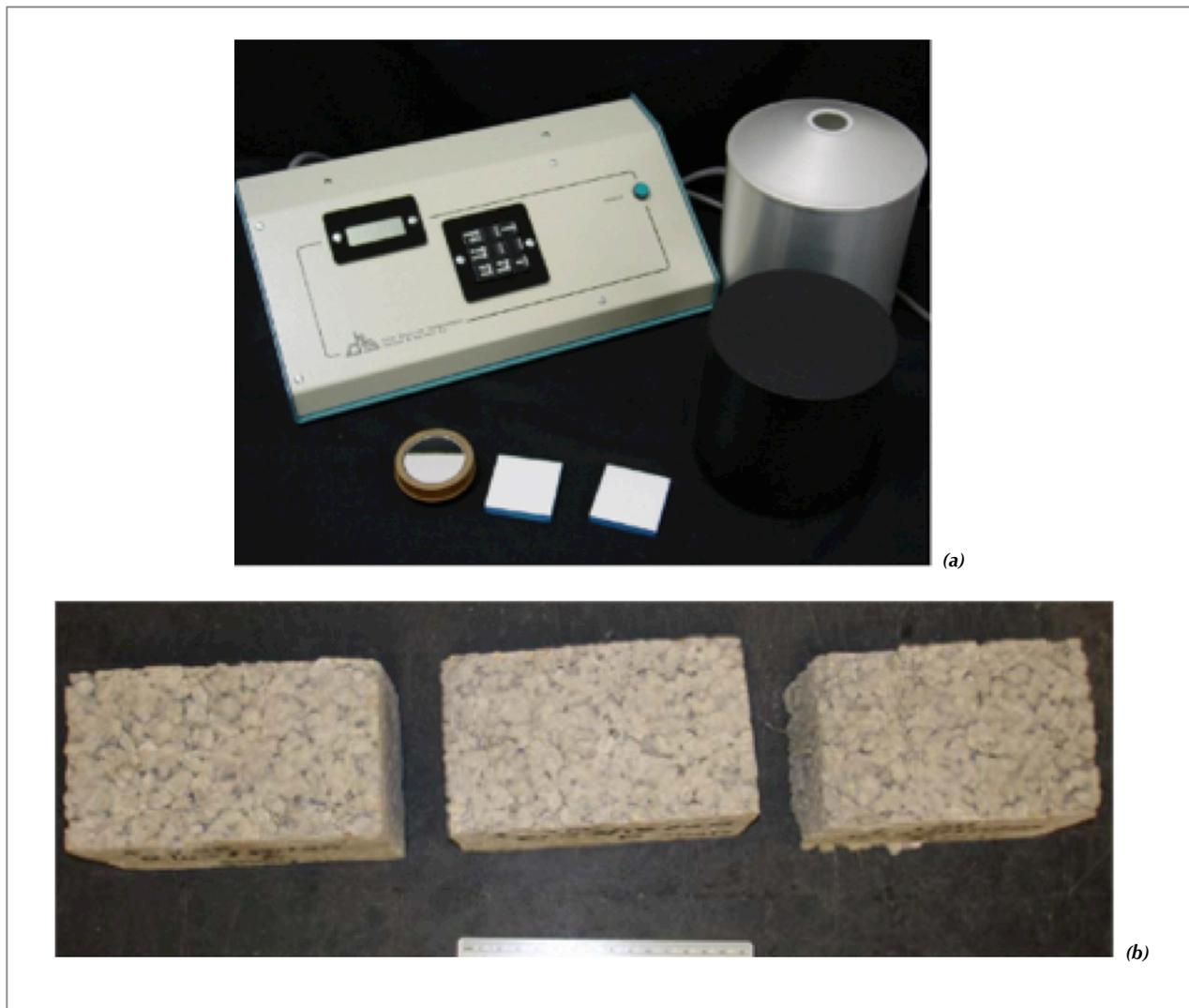
**Figura 1.** Ensayo de reflectancia solar; (a) Reflectómetro de espectro solar, (b) Muestras de ensayo
