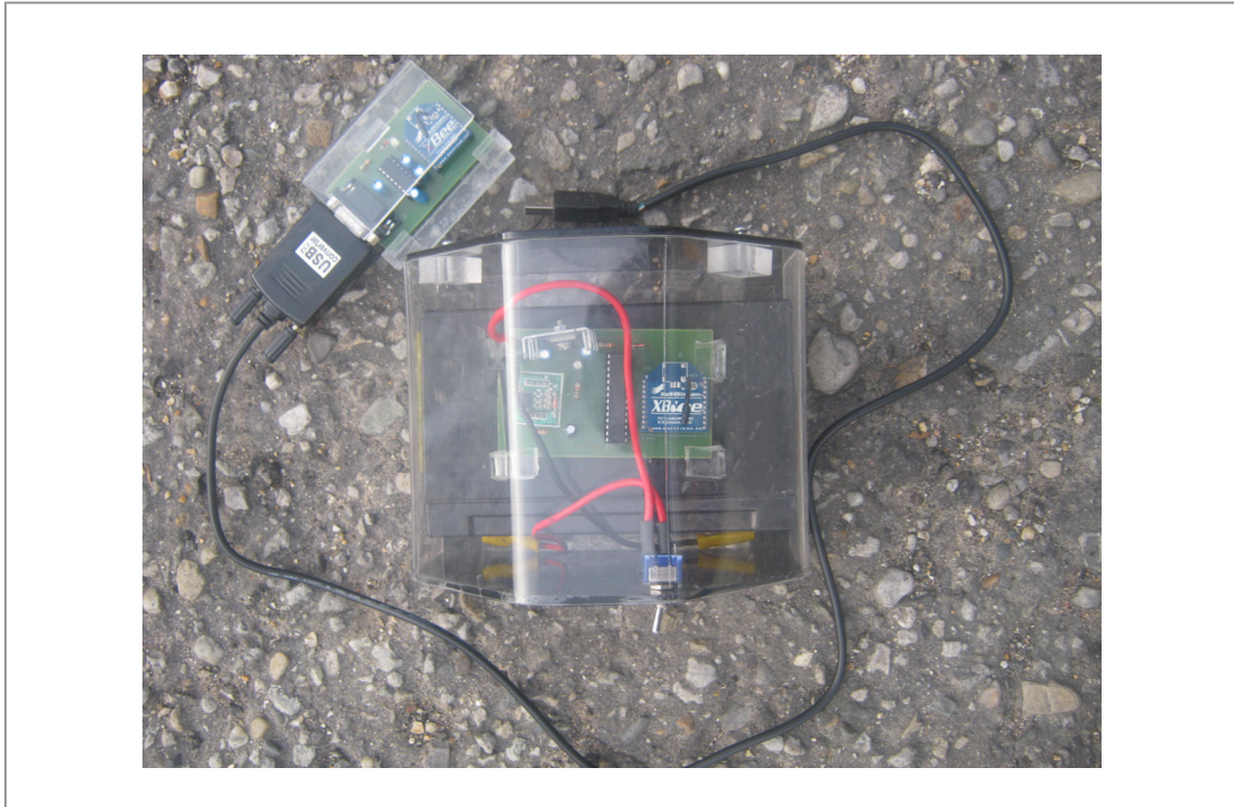
Figura 9. Prototipo para la detección de vibraciones Figure 9. Prototype Device developed to detect vibrations
