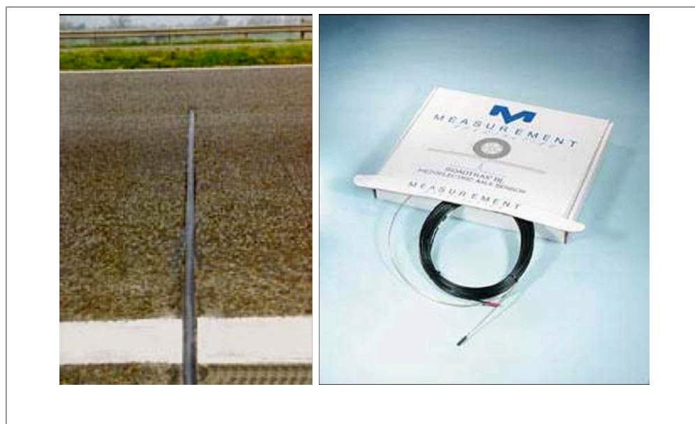
Figura 3. Sensor piezoeléctrico. Liu et al. (2006) Figure 3. Piezoelectric sensor. Liu et al. (2006)
