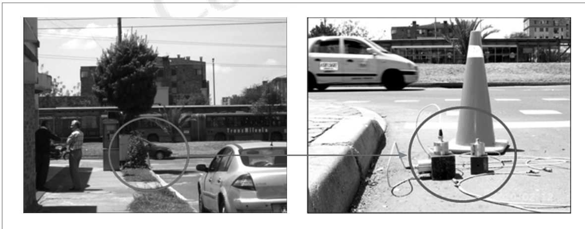
Figura 6. Disposición de los acelerómetros en dos diferentes configuraciones Figure 6. Accelerometers Arrangements under two different configurations
