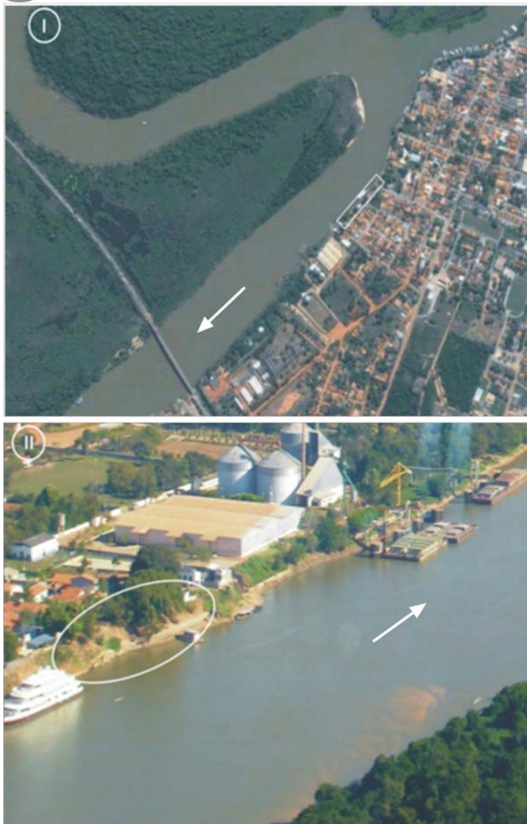
Figura 2 - Imagem da área estudada (I) e fotografia oblíqua da área onde pode ser observada a predominância da erosão na margem esquerda. Ao lado da área estudada em destaque, o principal Porto de embarque de mercadorias da hidrovía Paraguai-Paraná (Figura II) Fonte: imagem Quick Bird (2005) e Silva (2007).
