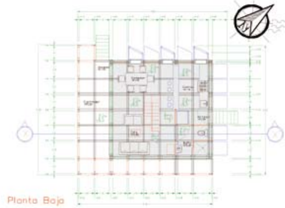
Podemos observar que la planta arquitectónica se compone de medidas mínimas pero cómodas para usuarios de familia de tres o cuatro personas, esta disposición puede cambiar de acuerdo con la necesidad del usuario, también puede crecer si así fuese necesario; su versatilidad proviene de una modulación y estandarización de la estructura, sus muros son ligeros y se adaptan al contexto, ya que la tablaroca es un buen material aislante para el clima caluroso.
