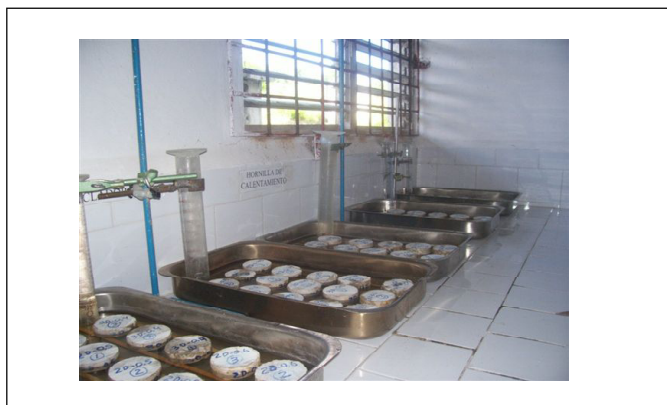
Fig. 3. Disposición de las probetas cilíndricas para el ensayo de absorción capilar.
