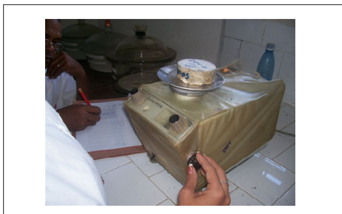
Fig. 2. Las probetas ya tratadas son pesadas antes de comenzar el ensayo de absorción.
