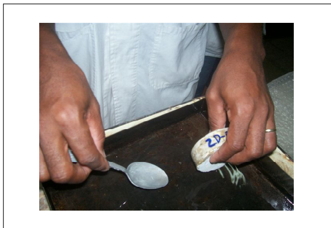
Fig. 1. Las probetas reciben tratamiento impermeable por los laterales con resina epoxi.
