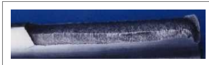
Fig. 2. Diente fracturado por grieta generada a lo largo del límite de la zona efectiva de cementado y provocada por escasa resistencia a la fatiga del material ante la carga aplicada. [1,2]
