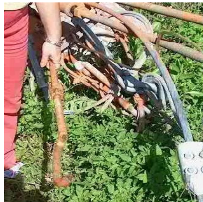
Fig. 10. Anclaje C a 2 m por encima de la base de la torre (proporcionado por ETECSA).
