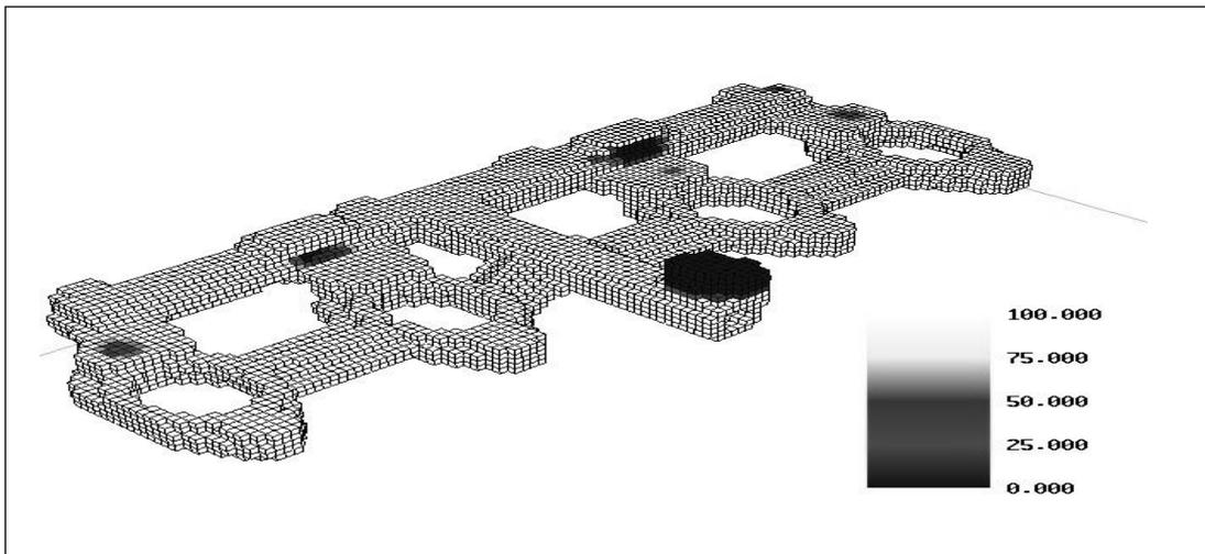
Fig. 1a). Resultados de la simulación, analizando los posibles rechupes. La escala de gris comprende desde 0 a 100% de llenado de cada elemento de la malla.
