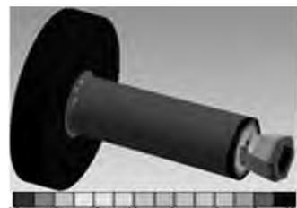
Figura 20. Eje GA1 (esfuerzo de von Mises)
