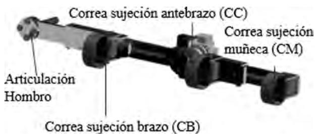
**Figura 3.** Zonas de contacto (sujeción) del exoesqueleto con la extremidad superior.
