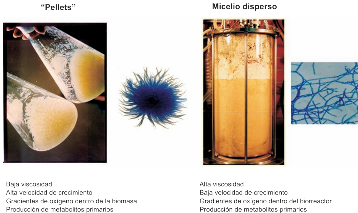
Figura 1. Influencia de la morfología miceliar sobre la hidrodinámica, transferencia de nutrientes y productividad de los procesos con microorganismos filamentosos.
