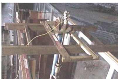
Figura 3 – Ponta limnimétrica fixada ao carrinho móvel sobre o canal.
