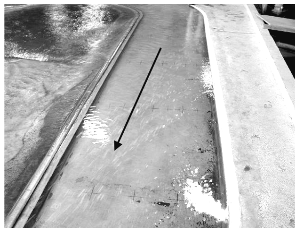
Figura 10 – Modelo Físico UHE Dardanelos – Vazão Q = 2.880 \text{ m}^3/\text{s} , trecho retilíneo do vertedouro lateral
