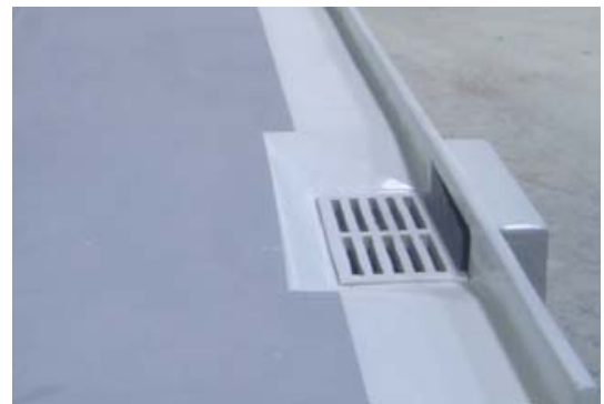
Figura 7 - Vista do modelo da faixa de rua dotado de sarjeta, boca de lobo com grelha e abertura na guia, revestido de fibra de vidro, resina e pintura.
