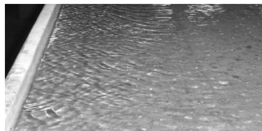
Figura 8– Aspectos do escoamento após o revestimento final da superfície do modelo
