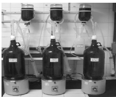
Figura 1 - Reatores anaeróbios de bancada
