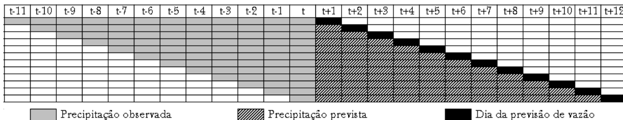
Figura 5 - Cálculo da variável precipitação média na bacia diária acumulada (Pma12(t)) em função do intervalo de tempo dentro do horizonte de previsão para o qual está sendo efetuada a previsão de vazão (o primeiro dia da previsão é t+1).
