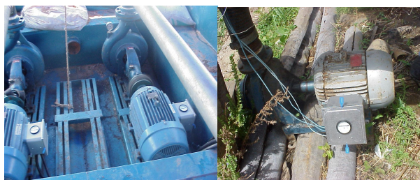
Figura 4 - Instalação típica de horímetros em bombas
