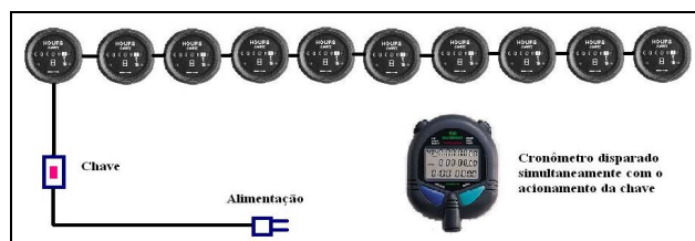
Figura 7 – Esquema da instalação de ensaio dos horímetros
