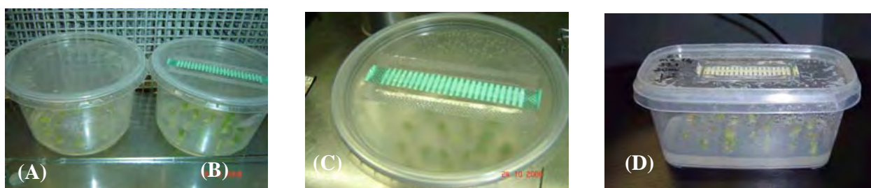
Figura 1: (A) Pote plástico transparente (PET) redondo sem filtro inserido na tampa, com mudas recém-inoculadas; (B) Pote plástico transparente (PET) redondo com filtro inserido na tampa, com mudas recém-inoculadas; (C) Aspecto detalhado da tampa com filtro, protegido por membrana Millipore. (D) Pote plástico transparente (PET) retangular com filtro inserido na tampa, com mudas recém-inoculadas
