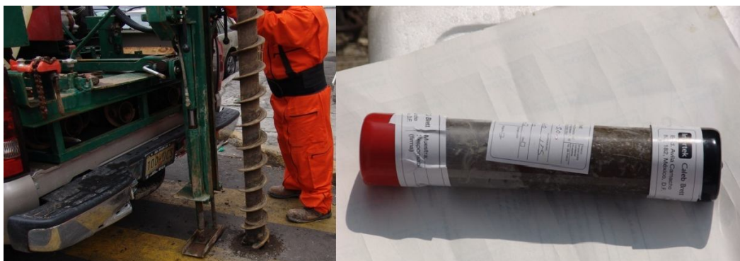
Figura 2. Detalles del trabajo de campo: perforadora hidráulica y muestras
