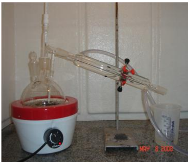
Figura 1. Aparato experimental utilizado para destilação de lixiviados de aterros sanitários
