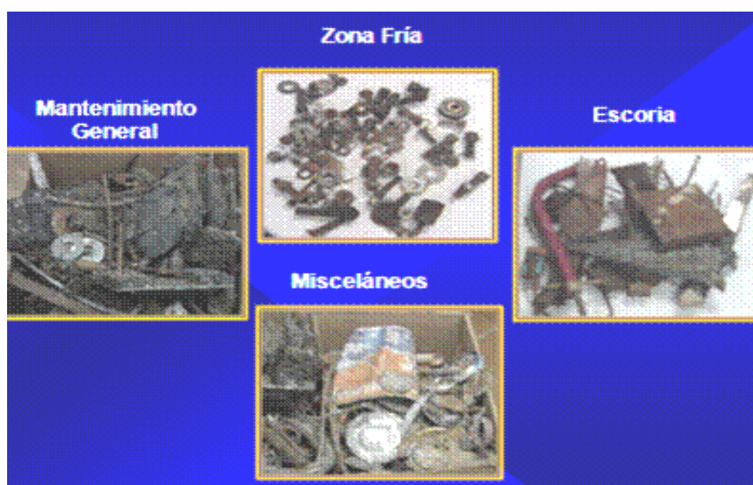
Figura 3. Metales encontrados en el casco inhouse provenientes de las diferentes zonas de incidencia por contaminación metálica
