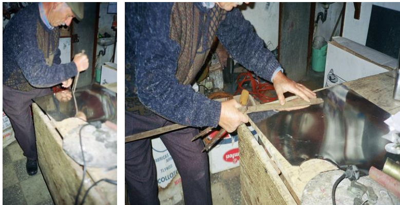
Figura 16. A folha de Flandres, o compasso de pontas secas e a régua não graduada
