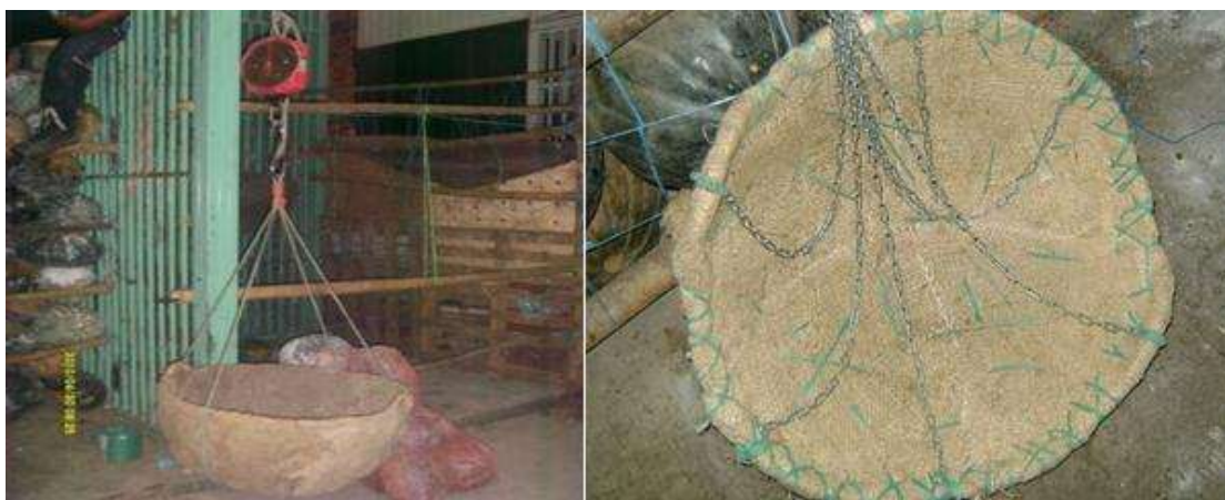
Figura 12. Pesa diseñada por los trabajadores con un canasto, costales de fique y cuerda gruesa.
