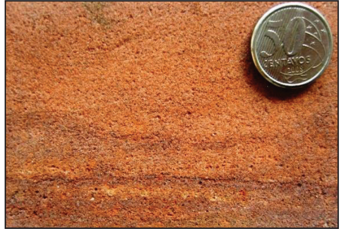
Figura 4 - Amostra de mão mostrando textura submatura e considerável porosidade intergranular primária residual nos arenitos da Formação Raizama
