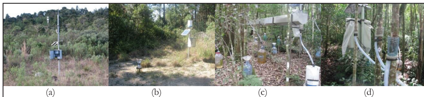
Figura 2 – Fotografias dos pontos de monitoramento: (a) estação meteorológica do rio Feio; (b) pluviógrafo de medição da chuva externa (P); (c) calha para coleta da chuva interna (Tf); e (d) mangueiras da coleta do escoamento pelos troncos (Sf)
