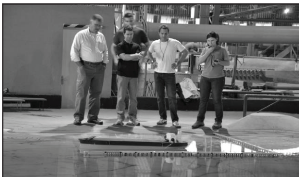
Figura 20 – Manobra comandada por prático via rádio para atracação de navio graneleiro da classe Ore Bayovar (180.000 tpb) no berço interno do TIG
