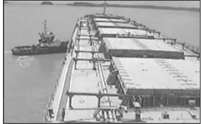
Figura 8 – Manobra real com auxílio de rebocadores para o navio classe Capesize no PDM Píer III, em lastro por boreste
