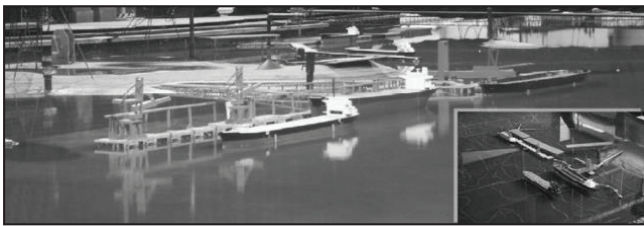
Figura 7 – SIAMA utilizando assistência de rebocadores para atracação por boreste do navio graneleiro classe Panamax (75.000 tpb) em lastro no Píer III de PDM
