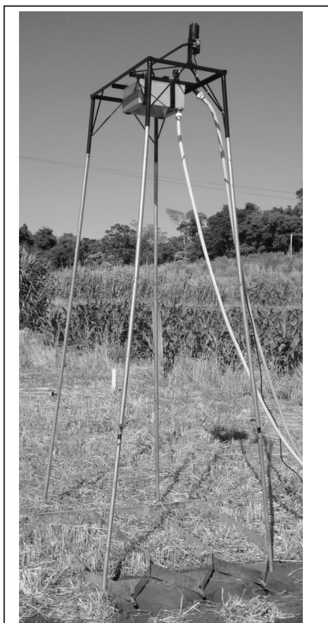
Figura 1 - Detalhe do simulador de chuva com bico pendular e estacionário e das calhas com espaço útil de 1,2 × 1,0 m, subdividido em três parcelas de 0,4 × 1,0 m instaladas sob o simulador de chuvas
