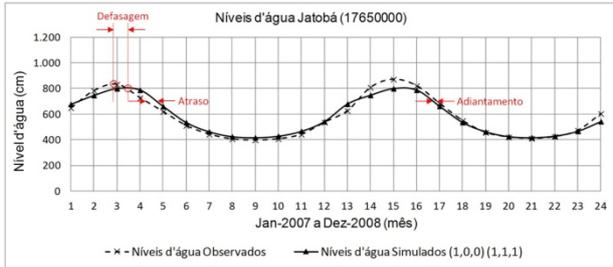
Figura 18 - Cotagramas dos níveis de água observados e simulados na estação Jatobá - Validação
