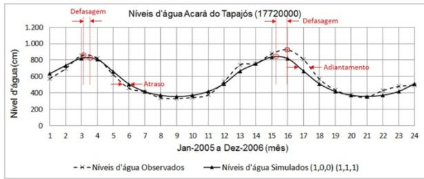
Figura 27 - Cotogramas dos níveis de água observados e simulados na estação Acará do Tapajós - Calibração
