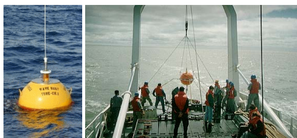
Figura 1 - Boia ondógrafo, à esquerda, e seu lançamento em Rio Grande, RS, em outubro de 1996 Fonte: Strauch (1999).
