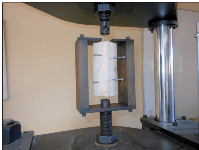
Figura 2. Ejecución del ensayo de extracción de clavos y tornillos.
