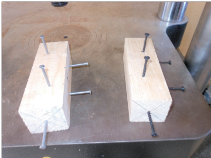
Figura 1. Probetas para el ensayo de extracción de clavos y tornillos.
