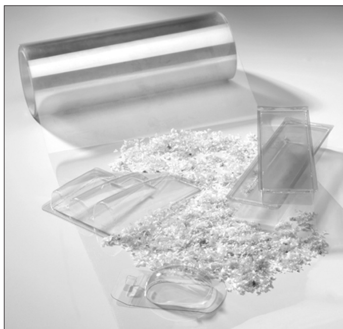
Figura 8. EcoStar es la planta en el estado del arte del reciclaje que muele y lava botellas de manera posterior al consumo para productos de termoformado. Imagen tomada de http://www.ecostarplastics.com/
