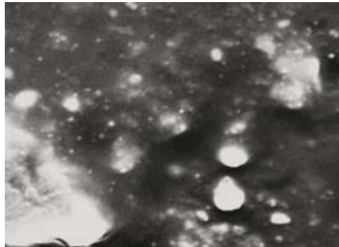
Figura 16. Asfalto del CIB con 1% de icopor (6000X)
