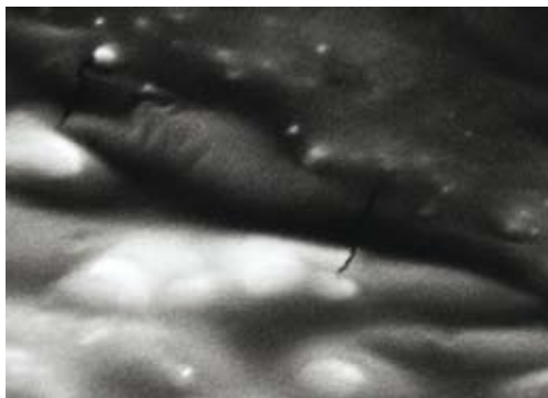
Figura 17. Asfalto 6000X con 1% icopor y 14% llanta (Ø no controlado)
