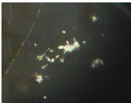
Figura 8. Asfalto del CIB con 1% icopor desoleizado
