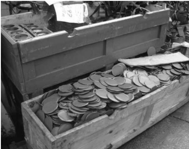
Figura 2. Residuos de material metaloplástico a la salida de una línea de producción de FracoPlay
