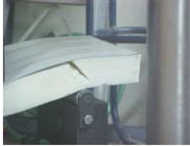
Figura 6b. Ensayo de corte en probetas: falla por corte en el poliuretano
