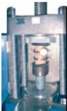
Figura 2. Probeta a compresión con deformímetro mecánico instalado.
