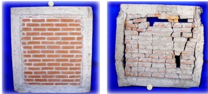
Figura 11. Muro de ladrillo antes y después de someterlo a compresión*
