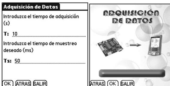
Figura 16. Configuración de los tiempos de adquisición y muestreo y de la adquisición de los datos.
