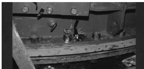
Figura 6. Sensor con roseta utilizado en Brida Inferior
