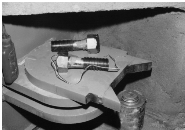
Figura 5. Sensores construidos a partir de Tornillos
