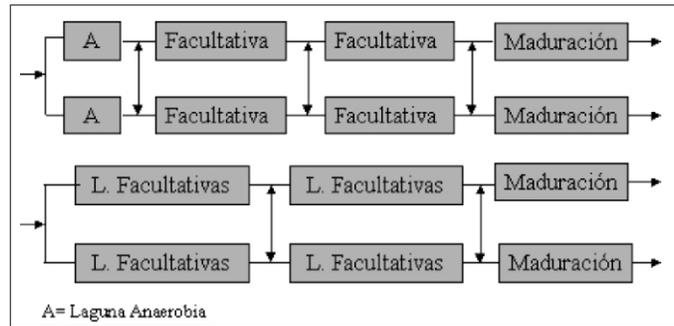
Figura 1. Diagramas de Flujo de Lagunas de Estabilización
