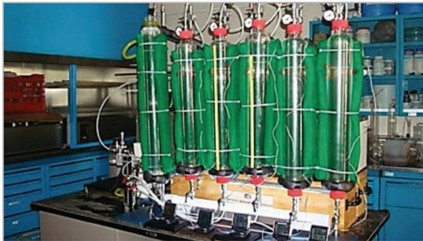
**Figura 8.** Equipo experimental de vidrio borosilicato para la evaluación de la estabilidad de espumas.
